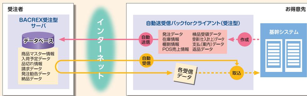
受注者が導入しているBACREX受注型サーバとEDIを行うお得意先のパソコン、またはPCサーバにインストールします。発注型と同様に、設定スケジュールにより自動送信・自動受信が行えます。送受信結果により後続プログラムを起動する機能もあります。この機能を利用すれば、基幹システムで作成したデータをフォーマット変換してから送信、その結果を基幹システムに通知するといった緊密な連携も可能です。(送信前処理用プログラムや後続プログラムは別途開発が必要)
